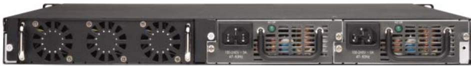
图1. Turbolron 24X配备热插拔电源和3组风扇
